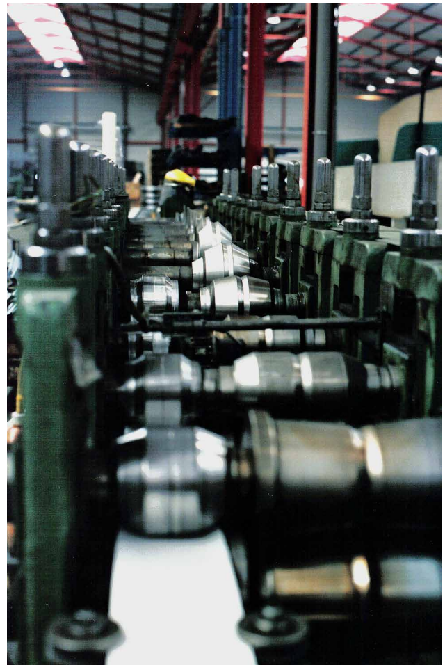
Profilbiegen des Ständerwerks.
