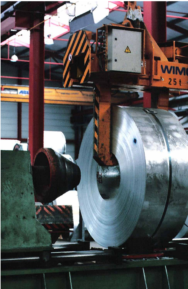
Handhabung der Coils mit Hebebrückensystem.
